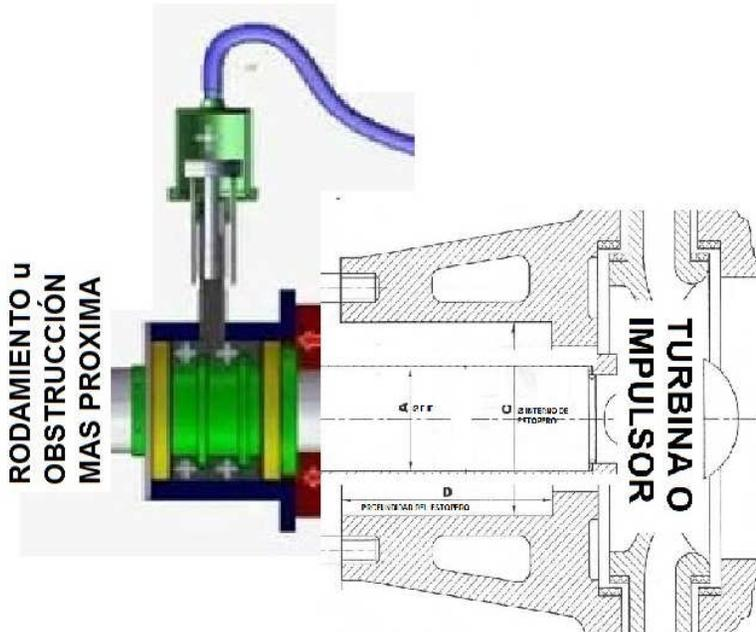
**EJEMPLO DE SELLO SECO MONTADO EN UNA BOMBA CENTRIFUGA**
